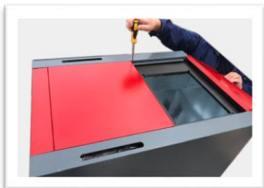
Desfaceți șurubul și ridicați capacul superior
